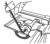
3. Wenn Sie im Uhrzeigersinn drehen (↻), vergrößert sich der Abstand zwischen den Gerätetüren. Durch Drehen gegen den Uhrzeigersinn (↺) verringert sich der Abstand. Passen Sie den Abstand zwischen den Gerätetüren wie oben beschrieben an.
